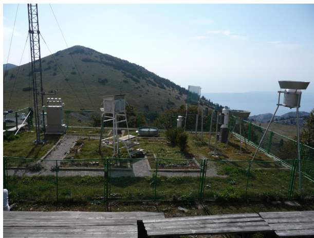
Slika 4. Opazovalni prostor na Zavižanu, desno zadaj je mreža za merjenje količine vode v megli. Foto: Zorko Vičar
